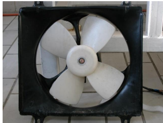
(b) Old radiator fan
